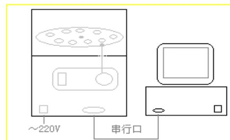
仪器应安装在水平的水泥板或其它无振动的工作台面上，并与墙壁或其它物体的间距不小于 1 5 0 毫米。
